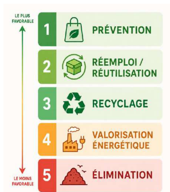
Figure 11 : Hiérarchisation des modes de traitement des déchets
