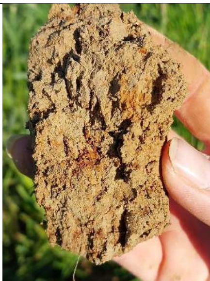
Présence de traces rédoxiques dès les premiers centimètres de sol. (S10 – 5 à 60cm)
